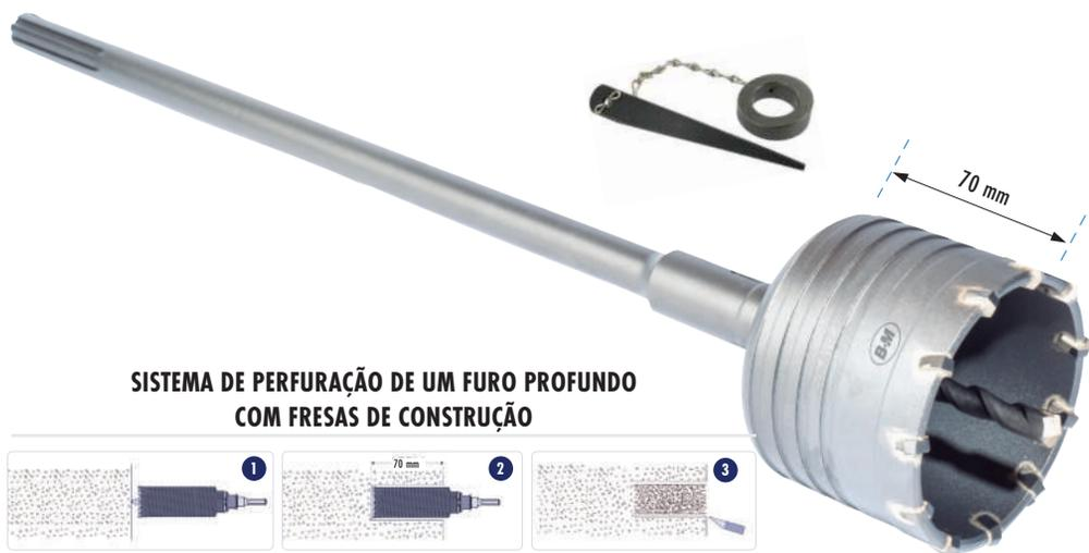
**SISTEMA DE PERFURAÇÃO DE UM FURO PROFUNDO COM FRESAS DE CONSTRUÇÃO**
