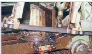
LAMA ROTTA, DENTATURA IN SENSO OPPOSTO
