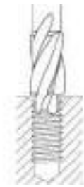
La fraise à lamer pour AVANT-TROUS s'utilise dans les trous avec filetage
